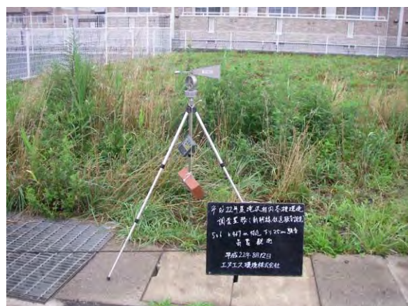
写真6：新幹線騒音調査気象観測状況
