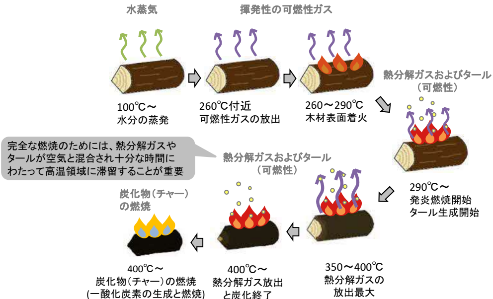
図 2-4 木材の燃焼プロセス
