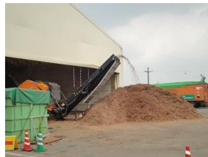
仮設処理施設での木くずの破碎(熊本県熊本市)
