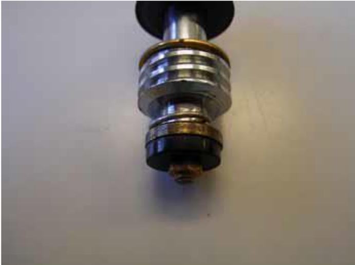
コマパッキンは金具等でスピンドルの下に固定しているものや、一体型のもの、ゴムのみ交換可能なもの、節水コマなど様々ありますが、写真のタイプはゴムのみ交換できます。コマパッキンが外れているタイプの場合は、蛇口内部からピンセット等でつまみ出し、新しいものに交換します。
