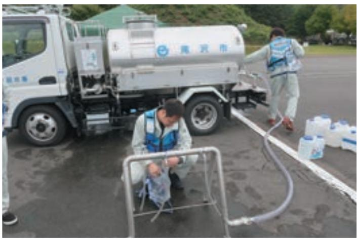
災害時の応急給水は給水車などを用いて学校や公民館などに給水所(給水拠点)を設けて行います。給水所には応急給水栓を用意し、市で所有している給水車や給水コンテナから水を供給して水道水を配ります。
