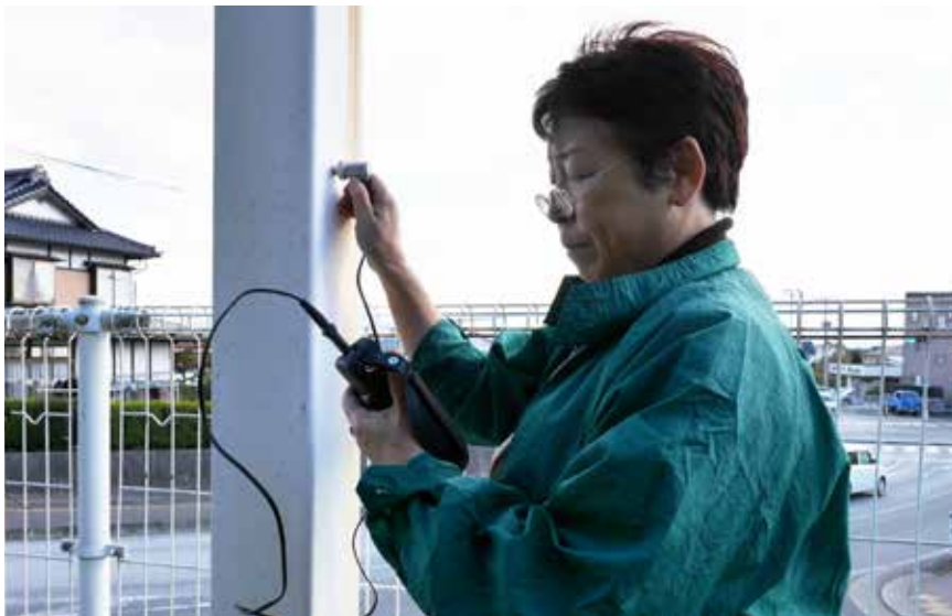
看板の柱の老朽化を調べる渡辺さん。倒れない安全な看板への熱意が伝わります。
